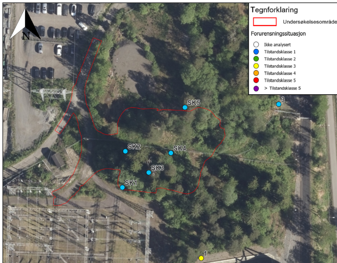
Figur 10: Situasjonsplan hvor forurensningstilstand er angitt med fargekoder iht. Miljødirektoratets tilstandsklasser. Figuren viser den høyest påviste forurensningstilstanden av et metall eller en forbindelse over og under en dybde på 1 m, uavhengig av type påvist forurensning. Figuren viser også punktene (1 og 3) fra den miljøgeologiske undersøkelsen utført av Multiconsult i 2018.
