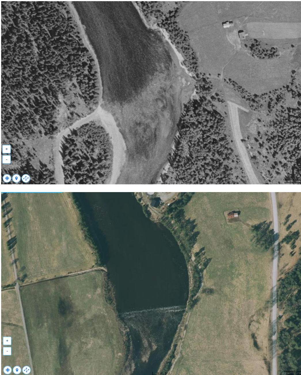
Figur 2. Sammenligning av elveløpet før (øverst) og etter (nederst) terskelbygging ved Gåsøyna (Terskel 10, Figur 4 ).
