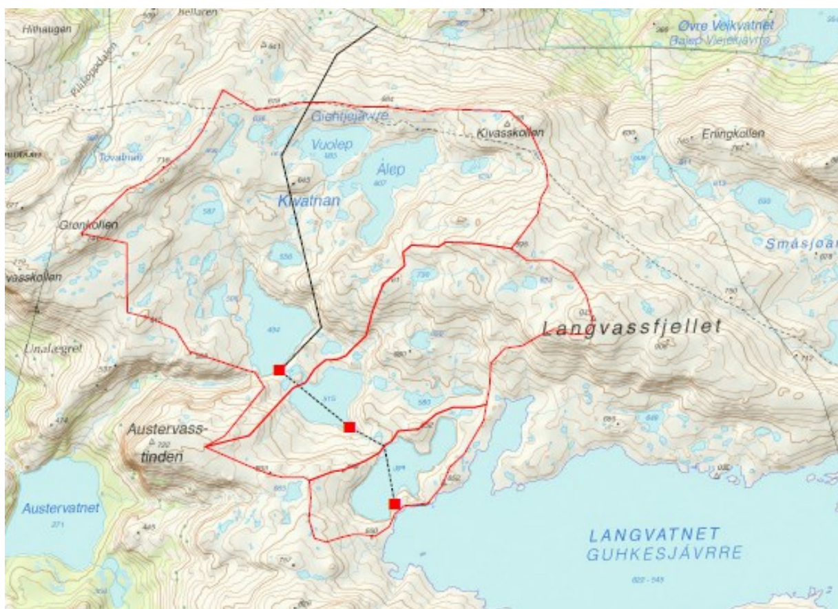
Figur 1 - Kart over omsøkte løsning med tre pumpestasjoner og 22 kV-ledning som skal forsyne pumpene med strøm. Pumpestasjoner er vist med rød firkant. Luftledning er vist med svart heltrukket linje og kabler i sjakt er vist med stiplet linje.
