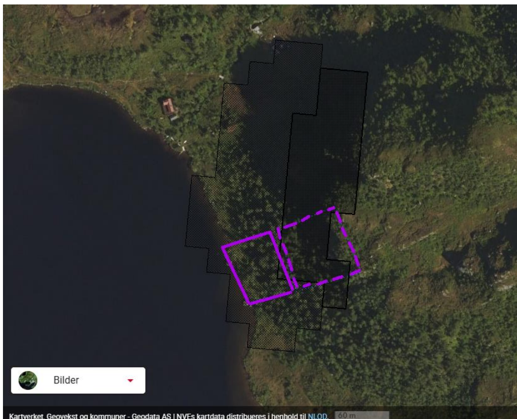
Figur 5 Aktsomhetskart for steinsprang og steinskred med potensielle løснеareal – ortofoto.
