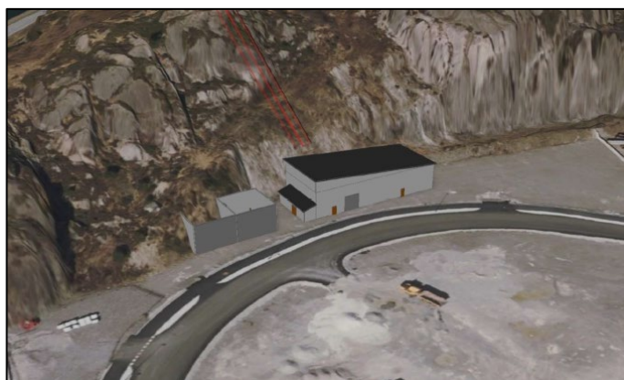
Figur 2 Viser tiltenkt plassering og utforming av transformatorstasjonen.
