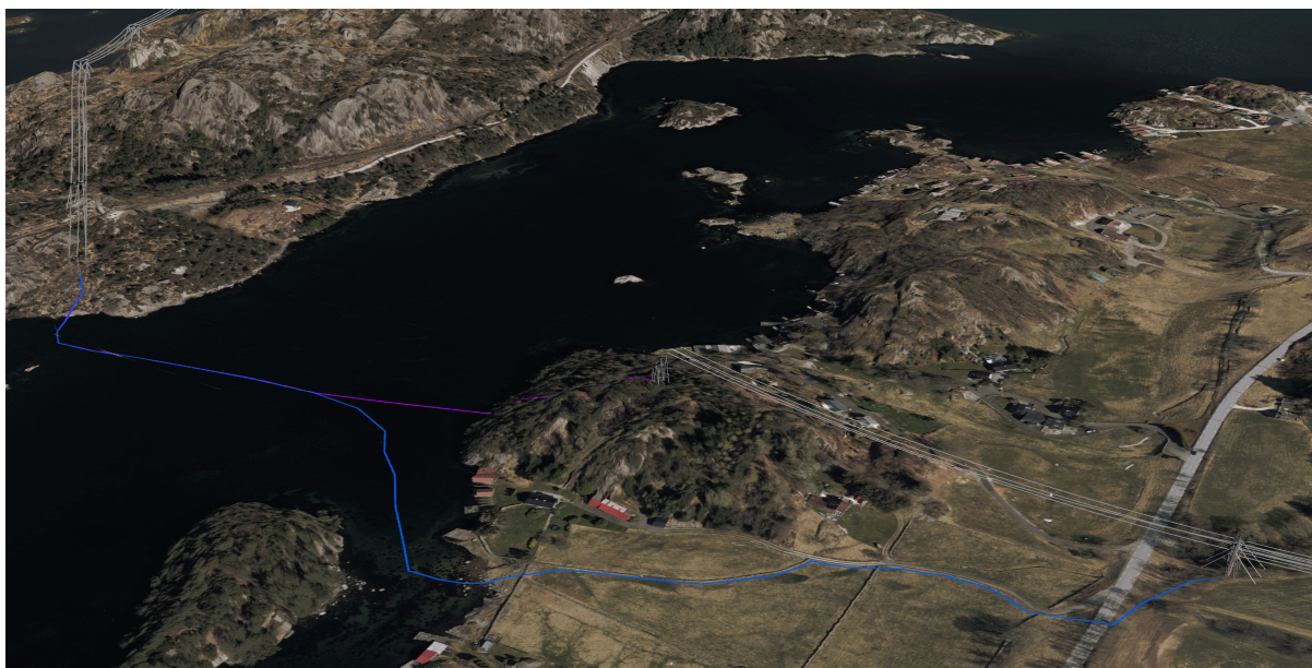
Figur 13 Utsnitt fra 3D-modell viser både alternativ 2 og 3 ved kryssingen av Nordra Sundet, sett fra sørvest. Alternativ 2 går i lang sjøkabel til endemast helt til høyre i bildet. Alternativ 3 går i kortere sjøkabel til endemast på kollen midt i bildet. Endemast på kollen midt i bildet og luftstrekk dit er kun del av alternativ 3.
