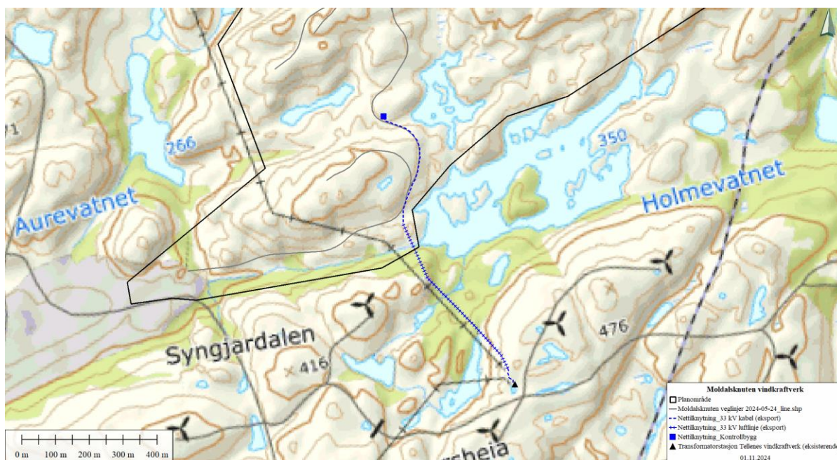
Figur 2-5 Kart som angir tiltenkt plassering av kontrollbygg og trasé for 33 kV eksportkabel/luftlinje
