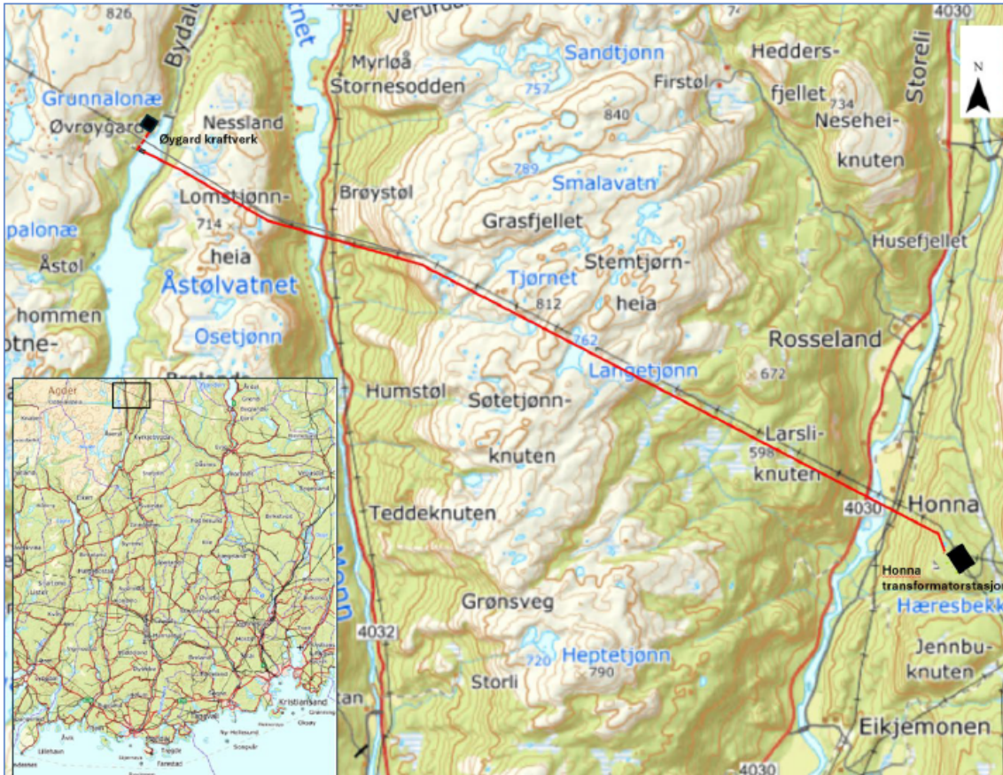
Figur 1.1 – Oversikt over tiltaket. Øygard kraftverk med ny 132 kV-kraftledning Øygard – Honna berører areal i Åseral kommune, Agder fylke. Rød heltrukken strek er ny 132 kV-kraftledning Øygard - Honna. Ny 132 kV-luftledning er planlagt fremført parallelt med - og på sydsiden av Statnetts eksisterende 420 kV-ledning Fjotland – Honna. Grå strek parallelt med rød strek er Statnetts nevnte 420 kV-ledning.
