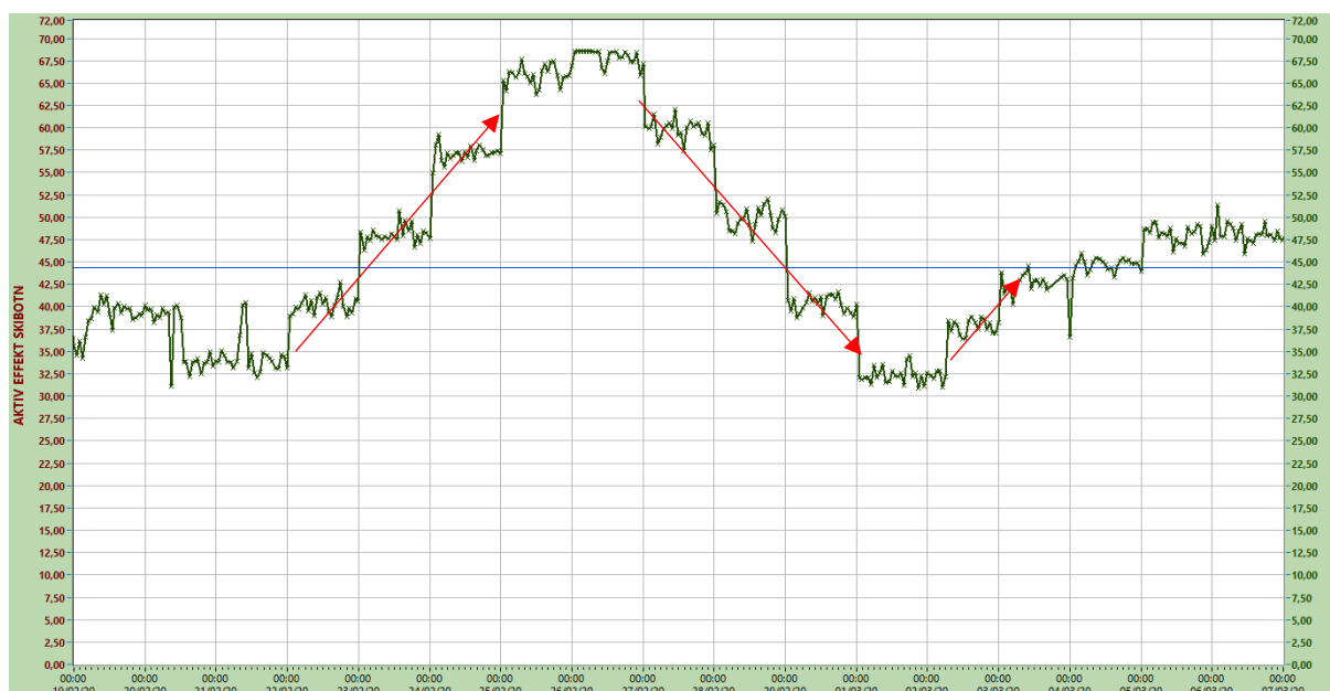
Figur 4-8: Eksempel på opp- og nedkjøringsplan fra 33 til 68 MW og tilbake (9 døgn)
