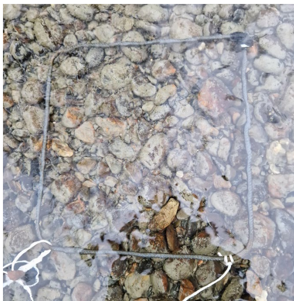
Bilde 6-2: Venstre: eksempel på fortettet/armert substrat på strekningen forbi Kiholmen. Ramma er 0,5x0,5 m Bilde 6-3: Høyre: eksempel på ikke armert substrat oppstrøms kraftverket. (Begge foto: Jenny Jensen, Akvaplan)
