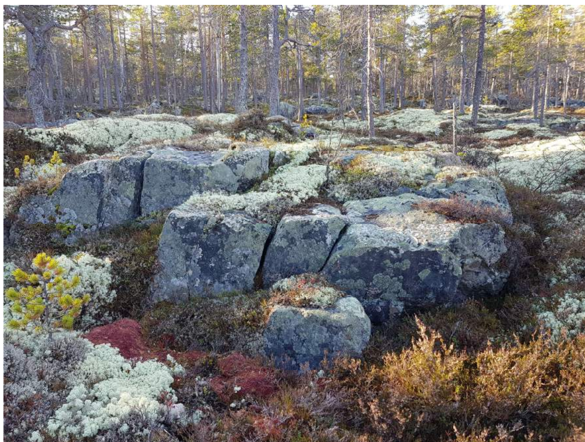
Bilde 2-2 Bilde av en typisk bergblotning. Bergflaten er ofte overgrodd av et tynt lag mose og lav. RQD er over 90.
