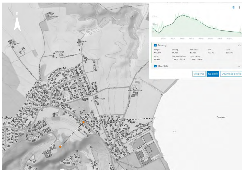
Figur 4-2 Terreng i snitt A-A (fra høydedata.no). Terrenghelling er 1:14.
