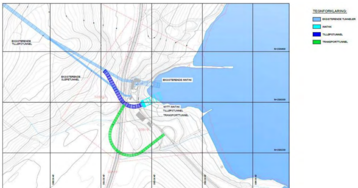
Planene inkluderer en ny inntakskonstruksjon i samme område som dagens inntak, med kort tilkoblingstunnel mot dagens tilløpstunnel (se figur 2). For gjennomføringen må det også drives ny tverrslagstunnel med adkomst fra inntaksområde.
