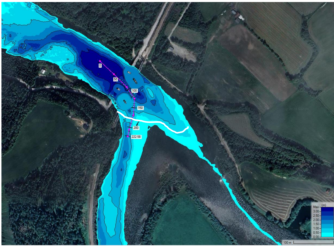
Figur 9 Kart som viser vanddyb ved en vannføring lik 50 \text{ m}^3/\text{s} i elva. Det se tydelig et mørkeblått parti oppstrøms bruene. Hvit strek viser de grunne partiene som stuver opp vatnet.
