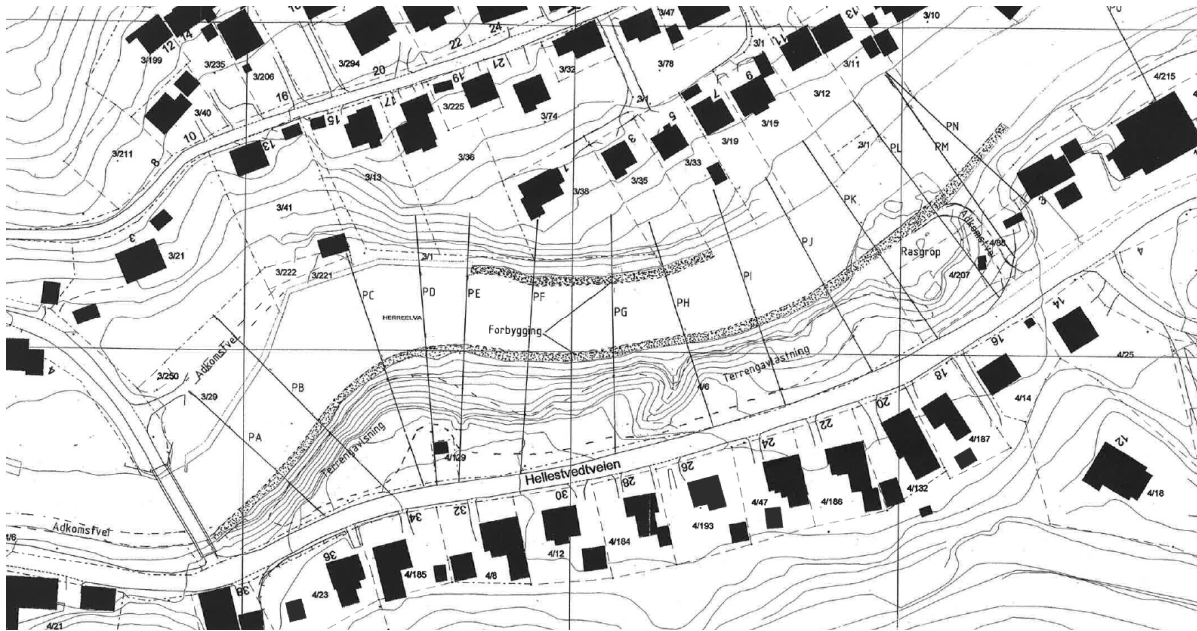
Figur 19. Områder med prosjektert erosjonssikring/erosjonssikret motfylling i elva, [2].
