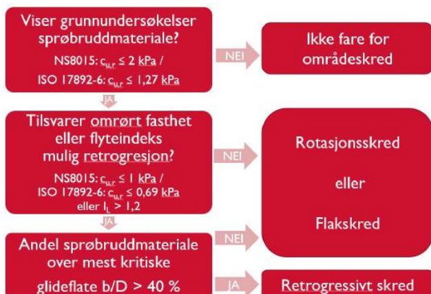
Figur 4 Flytskjema for vurdering av skredmekanisme (NVE veileder 01/2019)
