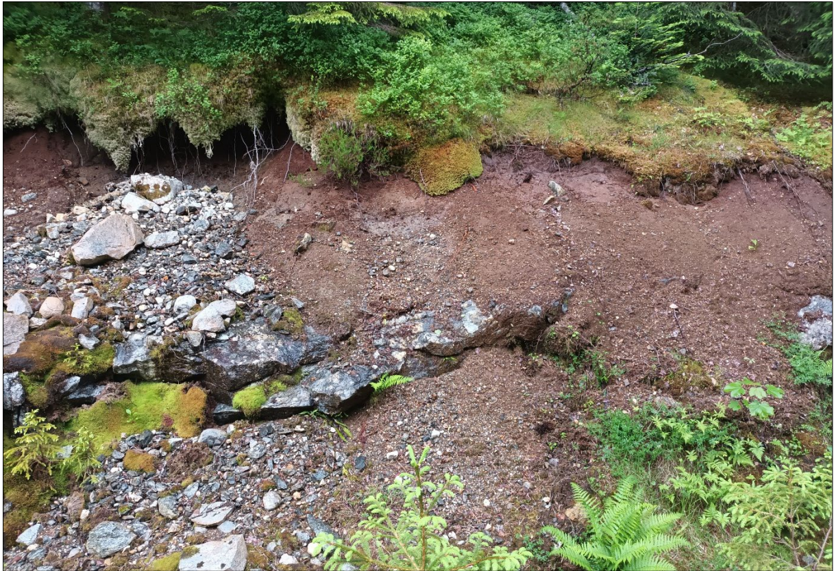
Figur 10: Biletet viser eksponerte lausmassar av morenemateriale langs skogsvegen ved infopunkt 7. Lausmassedekket er generelt tynt i store delar av påverknadsområdet (0,1 - 0,5 m).
