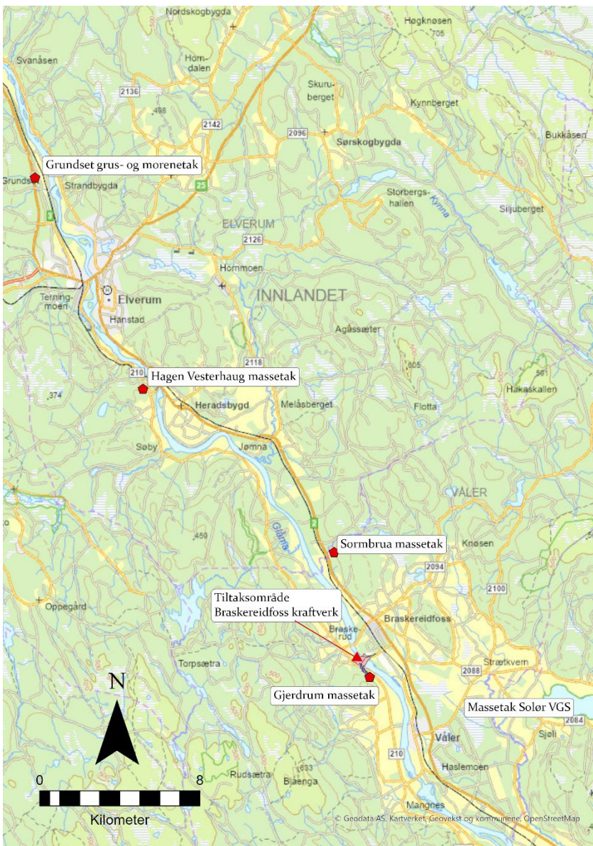
Figur 7. Oversiktskart hvor tiltaksområdet ved Braskereidfoss kraftverk er markert sammen med eksisterende massetak i området og hvor det er sannsynlig at det vil bli hentet masser til dambygging.
