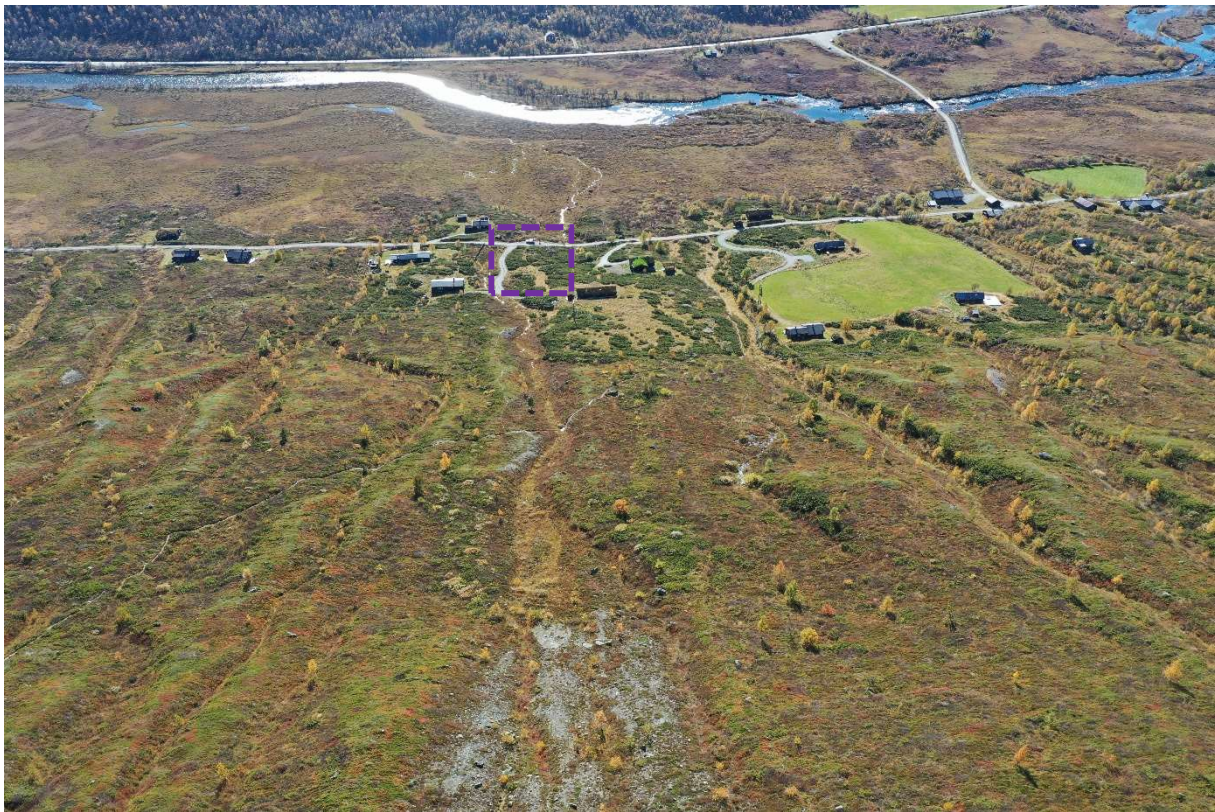
Figur 11: Dronefoto ned langs fjellsiden mot tomten, hvor tidligere skredsår og ravine/nedskjæring er godt synlig.
