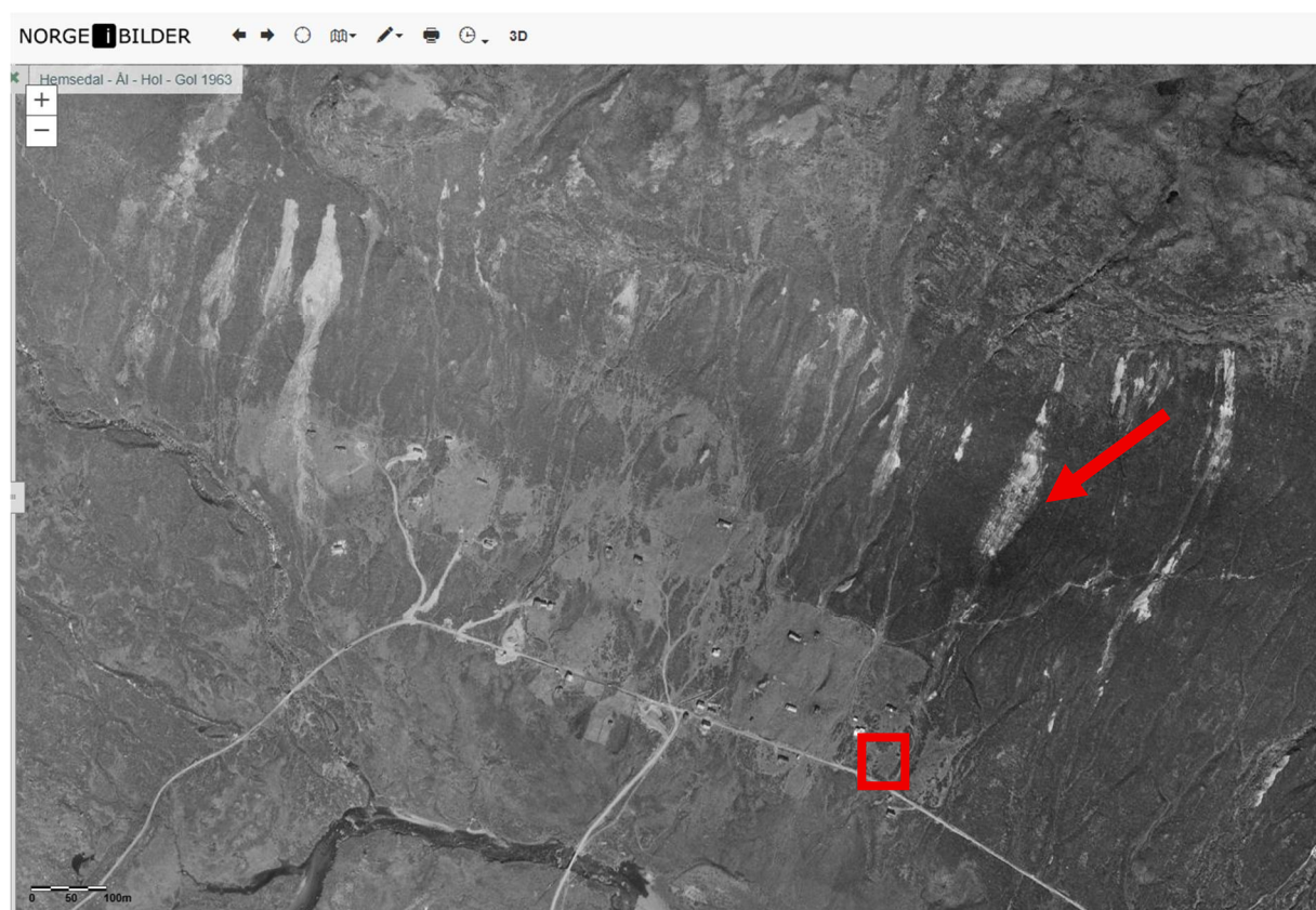
Figur 4: Flyfoto fra 1963 viser spor etter en rekke skred i fjellsiden. Tomten markert med rød firkant. (Statens vegvesen et al., 2025)(Statens vegvesen et al., 2025),
