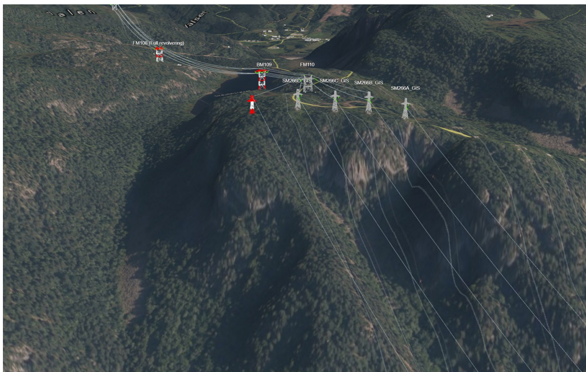
Figur 8: 3D skisse som viser eksisterende fjordspenn (grå fjordspennbukker) og nytt fjordspenn med rød/hvit fjordspennbukk på Karihaugen ved Sunndalsfjorden.
