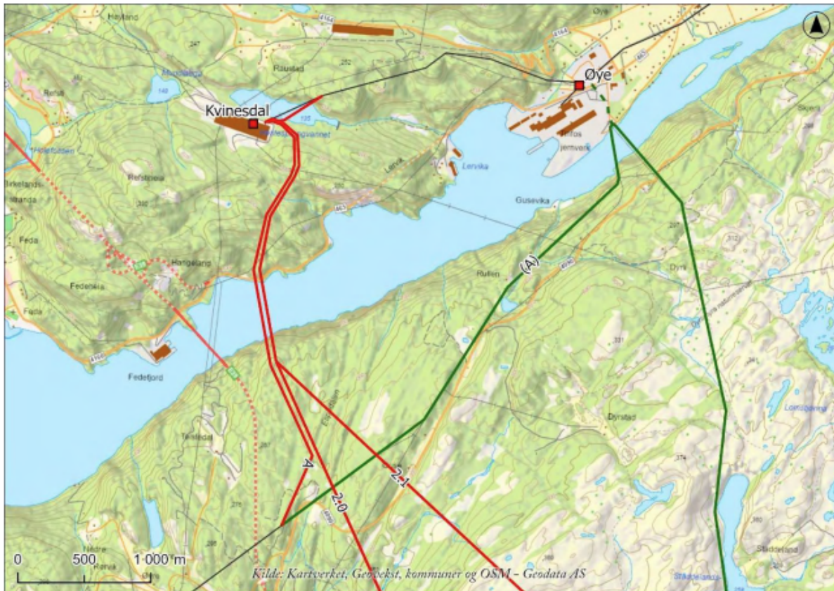
Figur 4517: Omlegging av 110 kV ledning fra Lista vindpark og inn mot Kvinesdal transformatorstasjon, vist med rød strek lengst vest merket A. Grønn strek merket (A) er tilsvarende ledning som rives. Kilde: Glitre Netts konsesjonssøknad.
