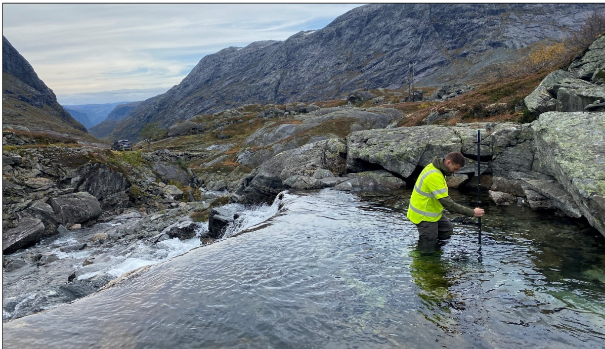
Figur 2-1: Feltarbeidet besto av dokumentasjon av forhold og innmålinger av punkt for å kunne sammenligne med eksisterende terrengmodeller og georeferering av observasjoner. For innmåling ble det benyttet en liten Leica GPS og digital målebok med ArcGIS Field Maps.
