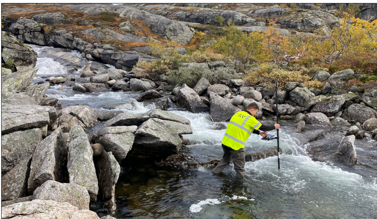
Figur 2-2: Innmåling av elvebunn og georeferering av bilder. For innmåling ble det benyttet en liten Leica GPS og digital målebok med ArcGIS Field Maps.
