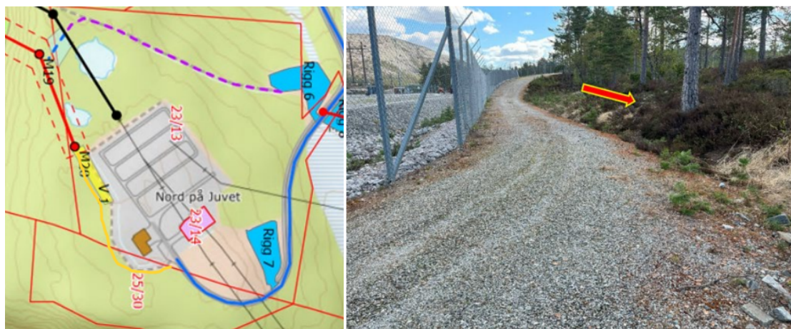
Figur 4 – Til venstre: innføring av 132 kV kraftledning til Honna transformatorstasjonen. Jordkabelens omtrentlige plassering er vist i gul strek. Kabelen skal legges i bakken vest for transformatorstasjonen. Til høyre: nåværende tilstand på området der det skal etableres vinsj- og trommeplass og kabeltrasé. Kilde: detaljplan 132 kV Øygard-Honna, 23.11.2025
