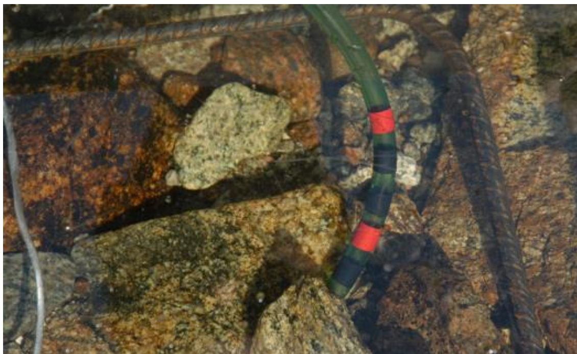
Figur 1 Metode for å måle skjul. Teipen på plastslangen indikerer hvor langt plastslangen kan føres inn mellom steiner. Stålramma definerer området som skal måles. Bilde: Forseth & Harby (2013).
