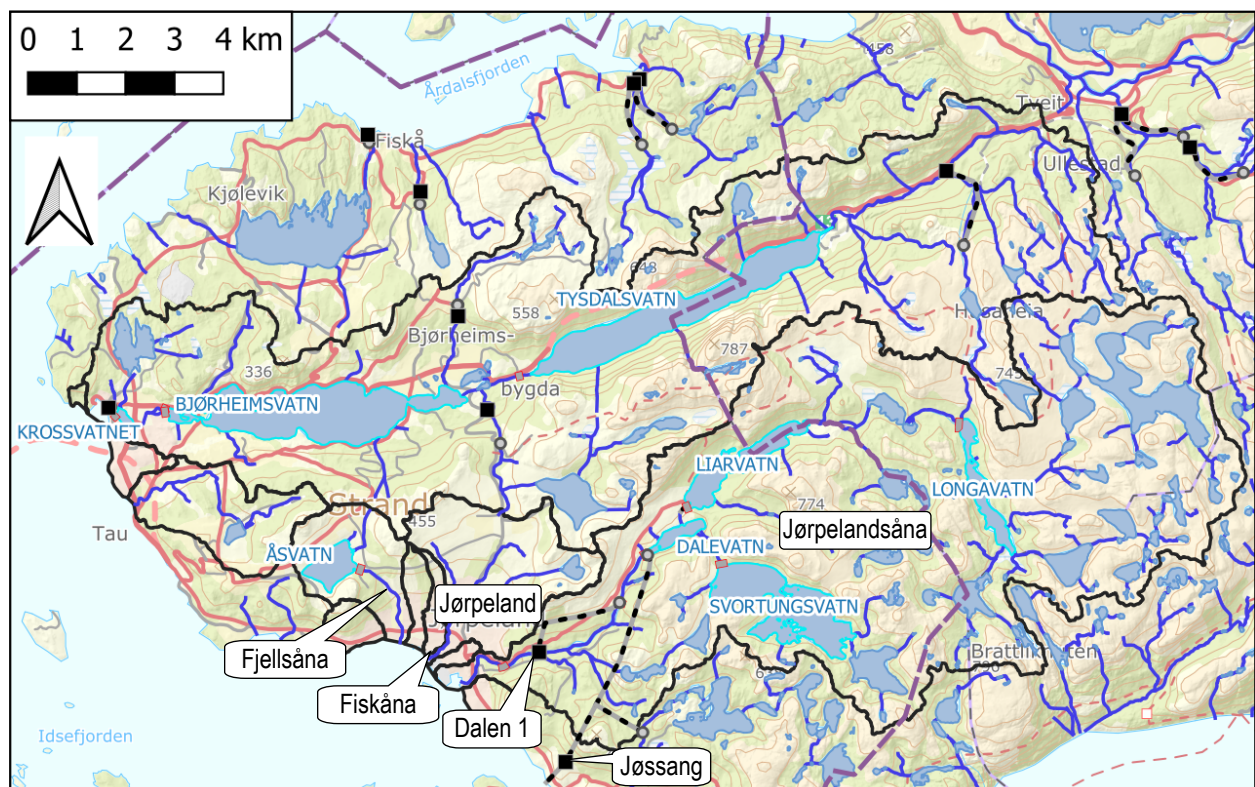
Figur 3.1 Oversiktskart over vassdrag i det kartlagte området. Nedbørfelt er vist med svart kant, magasiner med lyseblå kant, vannkraftverk med svart firkant, vanntunnel med stiplet svart-grå linje. Bakgrunnskart: Topografisk norgeskart, Kartverket; vannkraftdata: NVE.
