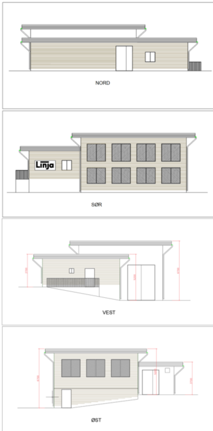
Figur 1-10 Fasadetegninger over omsøkt stasjonsbygg (Jøsok, 2023)
