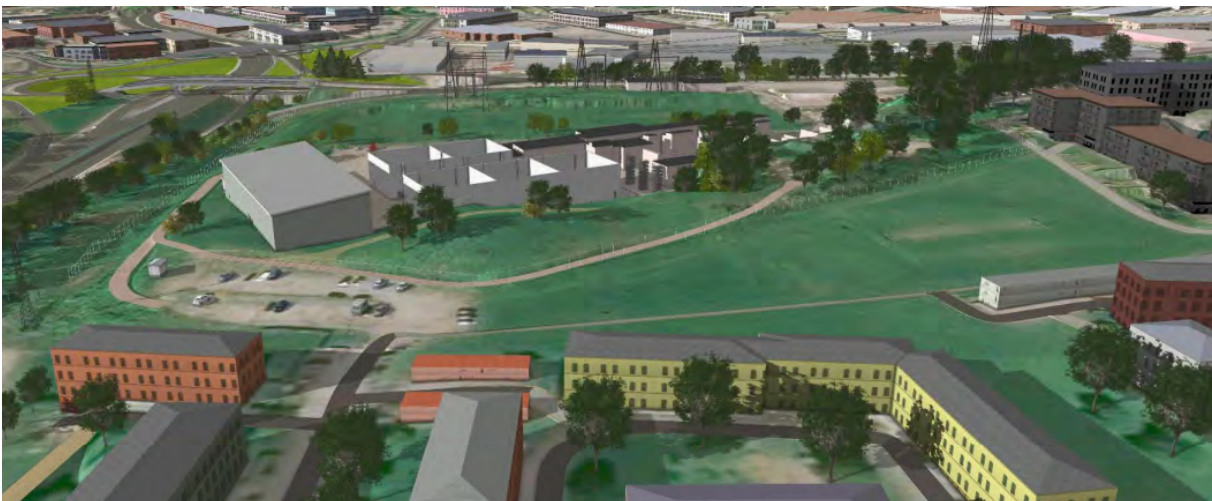
Figur 7. Visualisering av området etter bygging, fra sør (Karl Staffs vei). Nytt GIS-bygg og nye transformatorsjakter til venstre for midten. Luftisolerte anlegg som skal rives står i dag på grøntområde bakerst. Kilde: Statnetts søknad
