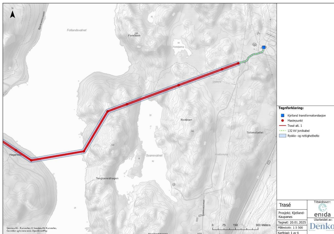
Figur 2-2 Kjelland transformatorstasjon – Svanevatnet – Fotlandsvatnet
