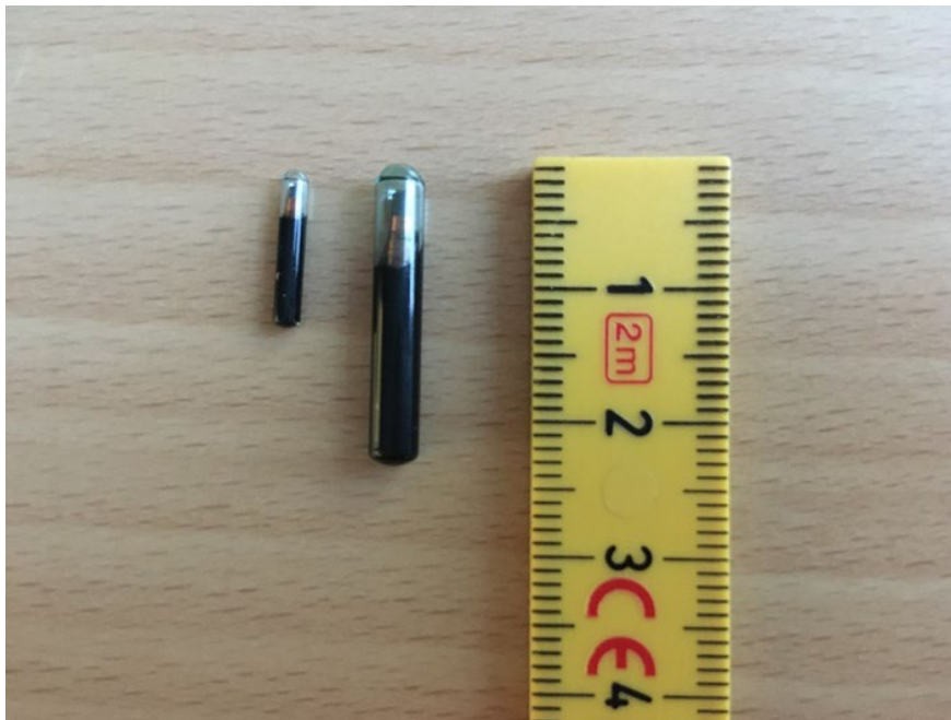
12 mm PIT-merke for villsmolt (venstre) og 23 mm PIT-merke for klekkerismolt.
