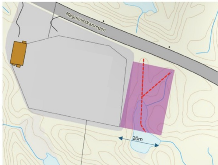
Figur 5: Magnhildskaret koblingsstasjon etter utvidelse. Lilla rektangel viser utvidet areal. Rød, stiplet strek viser vannrør.
