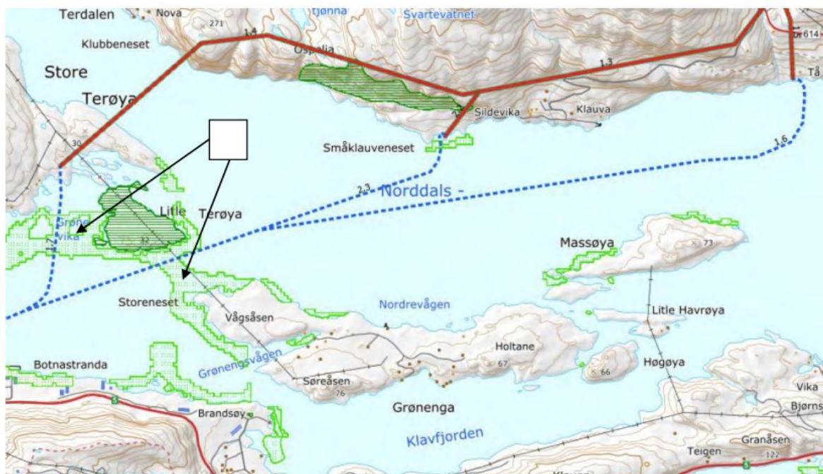
Figur 19: Områder med tareskog markert med lysegrønn farge. Traséalternativ B vil gå gjennom et mindre område med tareskog ved Småklauveneset. Både traséalternativ A og B vil gå gjennom større områder med tareskog ved Litle Terøya. Traseen som krysser Norddalsfjorden over til Store Terøya er trukket av Linja.
