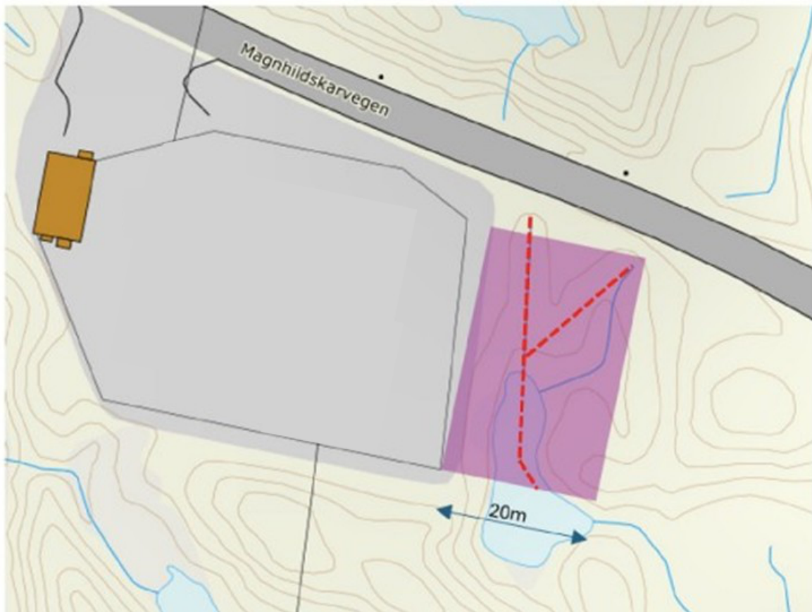
Figur 27: Utvidelse mot øst av Magnhildskaret koblingsstasjon markert med lilla rektangel. Vannrør markert med rød stiplet linje.
