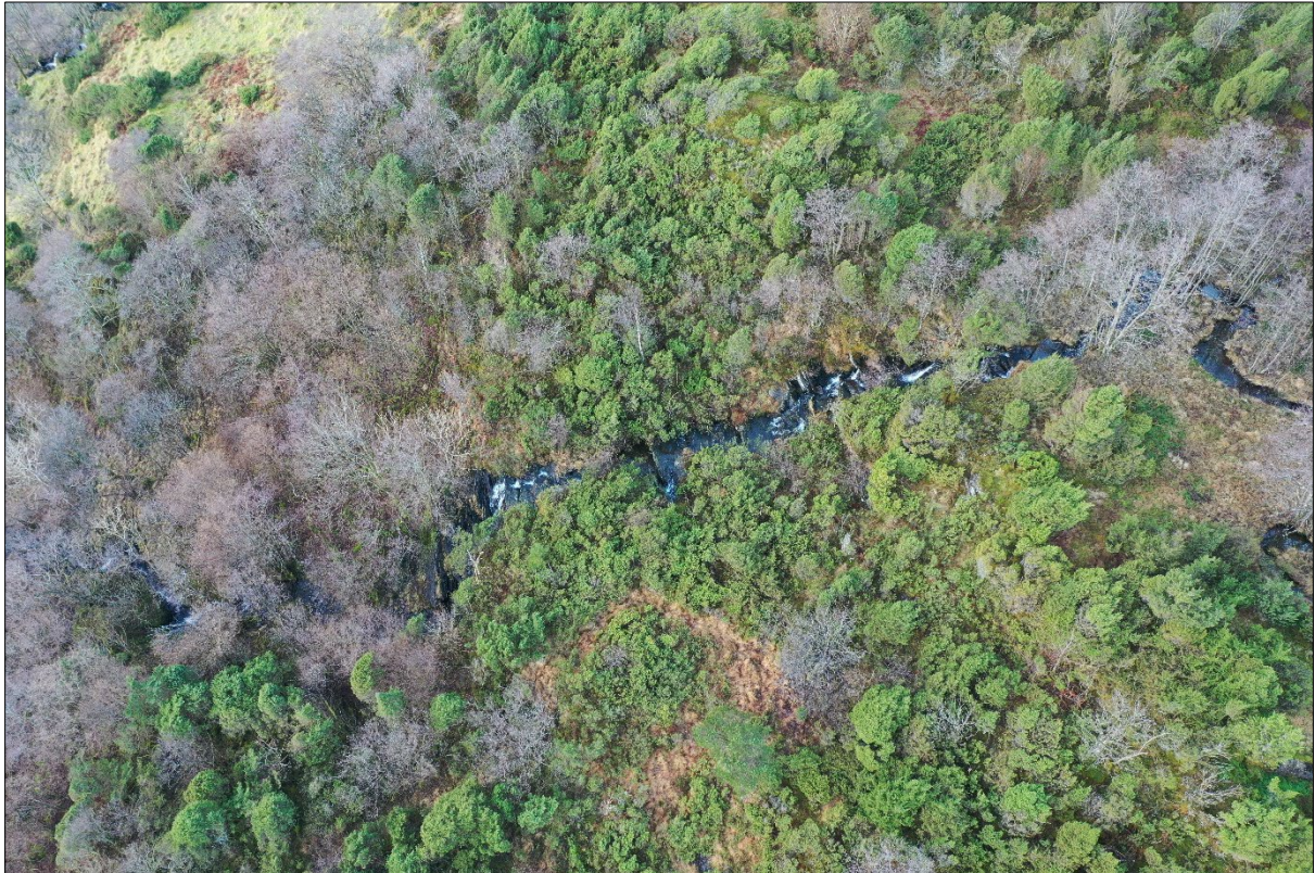
Figur 132: Dreneringsvegen i austleg del av påverknadsområdet. Dreneringsvegen renn ut frå eit flatt parti, til høgre i biletet (infopunkt 3). Dreneringsvegen renn hovudsakleg på fast fjell i heile løpet ned mot kartleggingsområdet.
