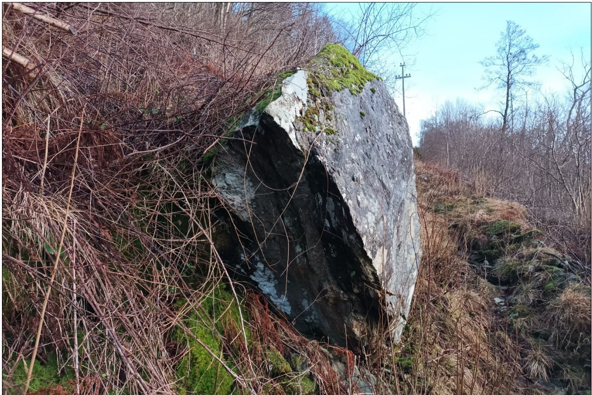
Figur 129: Stor, kanta blokk ( >2 \text{ m}^3 ) ved infopunkt 11. Blokka er tolka å vere av same bergart som fjellpartiet direkte ovanfor, og tolka som ei steinsprangblokk. Losneområde for ei blokk på denne størrelsen vart ikkje observert, og det er vurdert at kjeldeområdet ovanfor i dag er vesentleg redusert og ikkje vil produsere steinsprang på denne størrelsen.
