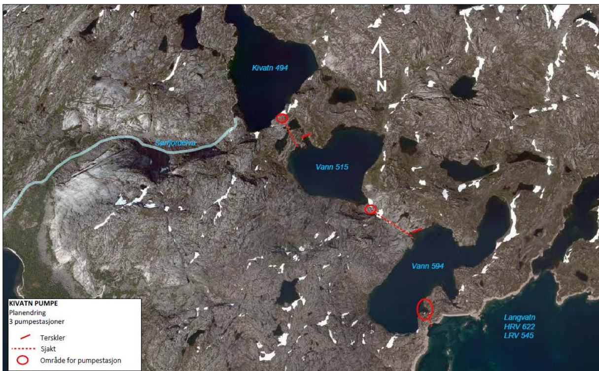
Figur 1. Kivatn pumpe. Planendring. 3 pumpestasjoner. Prinsippkisse.
