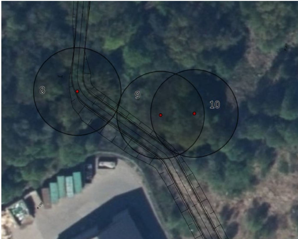
Figur 5-15 Hule eiker ved planlagt veg til utløpet.
