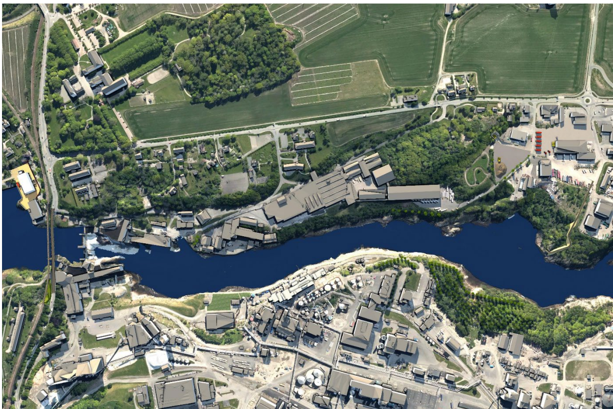
Figur 5-8 Totalvannføring 728 m 3 /s (middelvannføring), 350 m 3 /s går i Sarp 2 og 378 m 3 /s går i elveløpet. Visualisering: Norconsult
