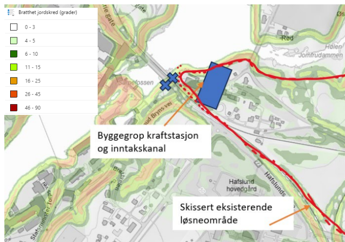
Figur 5-4 Bratthetskart fra NVE. Skråningshelning 1:15 tilsvare 3,8 grader. Det vil si at alle skråninger med farge har potensiale for å være et løøgneområde. Blå kryss indikerer berg i dagen. Skisserte løøgneområder er vist med røde streker.
