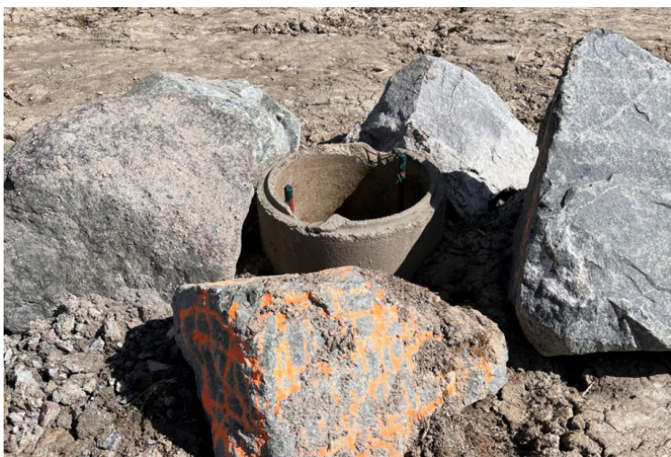
Figur 5-5 Eksempel på tydelig markert piezometerrør (rød stang) med fysisk beskyttelse.
