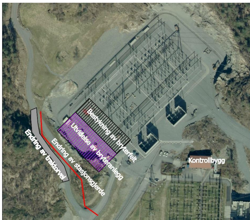
Figur 6. 420 kV-anlegget i Saura transformatorstasjon utvidet med ett felt i sørvestlig retning. Meldte tiltak vil også innebære justering av stasjonsgjerdet og noe omlegging av eksisterende traktorvei.
