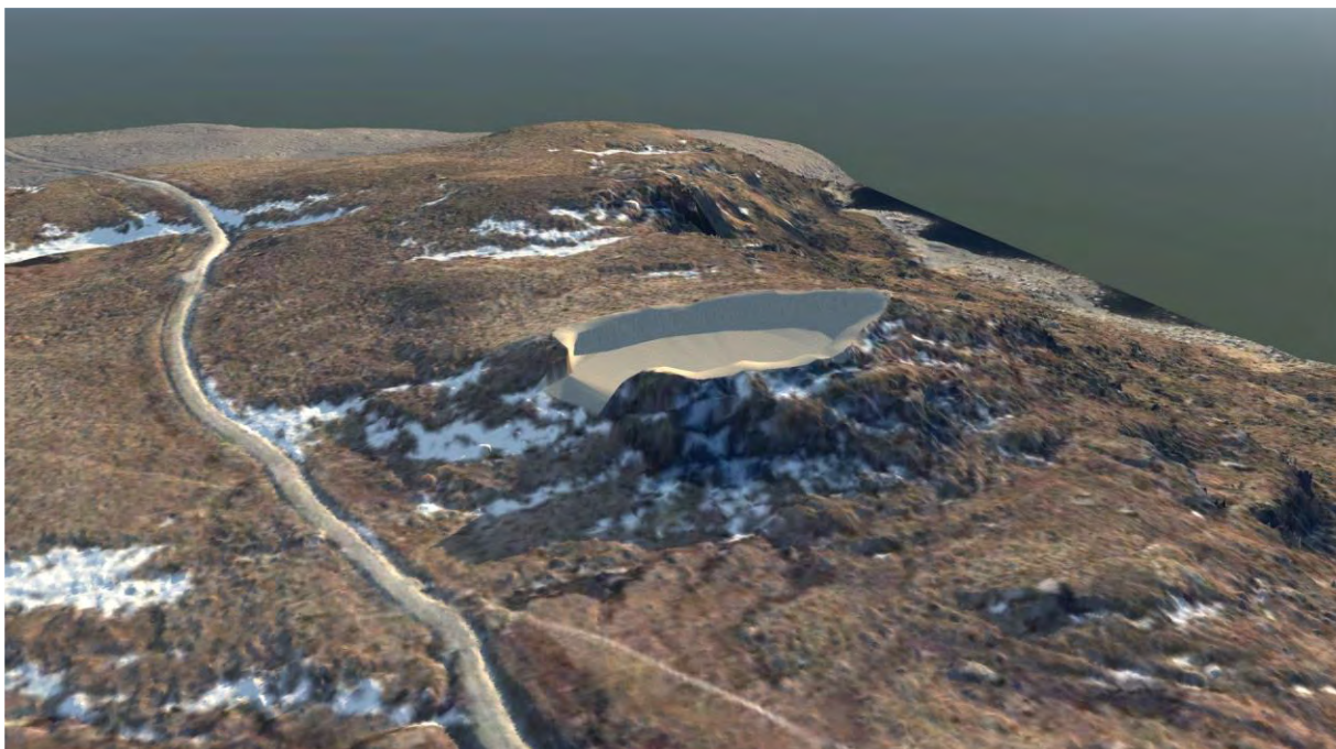
Figur 2-3 Antatt form på ferdig utsprengt steinbrot ved uttak av 16 000 m 3 faste massar, før oppfylling og istandsetjing. Inngangen til steinbrotet kan bli utvida mot sør pga. bergtekniske forhold.
