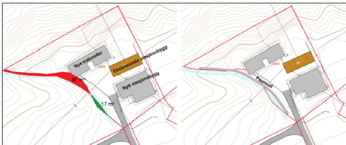
Figur 2: Situasjonsplan som viser nytt stasjonsbygg og nye transformatorceller på nye Bø transformatorstasjon markert med grå firkanter. Eksisterende stasjonsbygg, som Linja søker om å rive, er markert med mørk oransje farge. På kartet til venstre er nytt areal som må eksproprieres markert med rødt og areal som frigis markert med grønt. På kartet til høyre er den nye flomvollen tegnet inn med grå farge. Kilde: Linjas søknad av 21. mai 2025.
