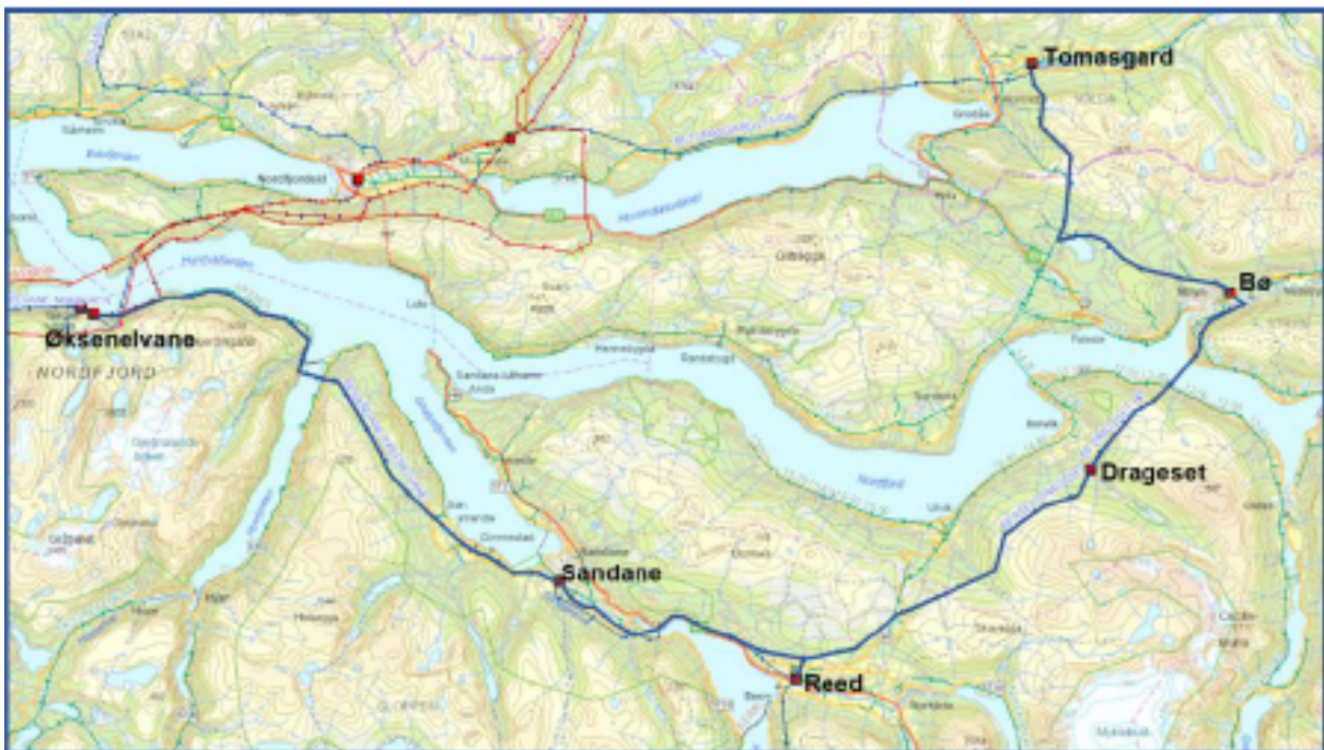
Kart 3: Kartet viser en oversikt over hvor Linja søker om tiltak. De søker om å erstatte deler av ledningen mellom Tomasgard og Bø transformatorstasjoner. Videre søker de om å erstatte Bø transformatorstasjon. I Tomasgard, Drageset, Reed og Sandane transformatorstasjoner søker de om spenningsoppgradering. De søker også om å rive ledningen mellom Sandane og Øksnelvane transformatorstasjoner. Kilde: Linjas søknad av 21. mai 2025.
