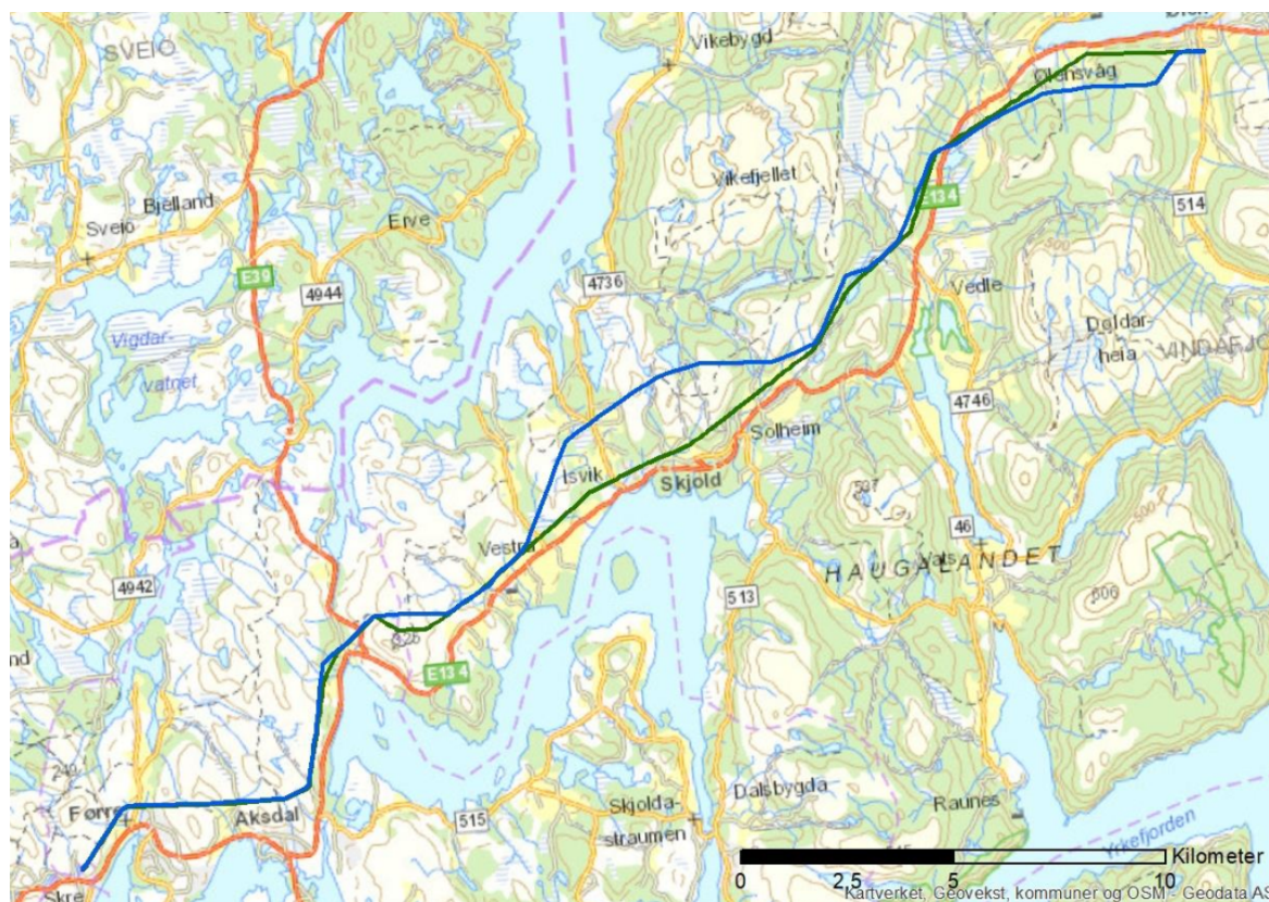
Figur 1: Plassering av ny 66 (132) kV luftledning Ølen-Våg-Bratthammer. Blå strek viser den nye ledningen, mens grønn strek viser ledning som skal rives.
