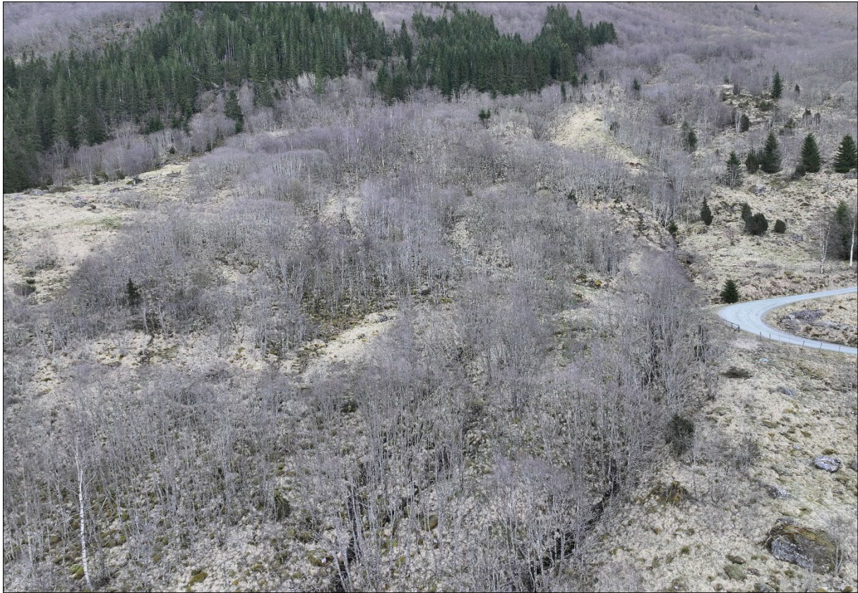
Figur 10: Dronebilde av nedre del av fjellsida i aust. Terrenget er småkupert av underliggende blokkformer, men det er danna stabilt jordsmonn og terrenget er dekt av vegetasjon. Det er tolka at lausmassane hovudsakleg består av gammalt skredmateriale av steinsprang/steinskred som er transportert lenger ned av jord- og snøskredprosessar. Infopunkt 6.
