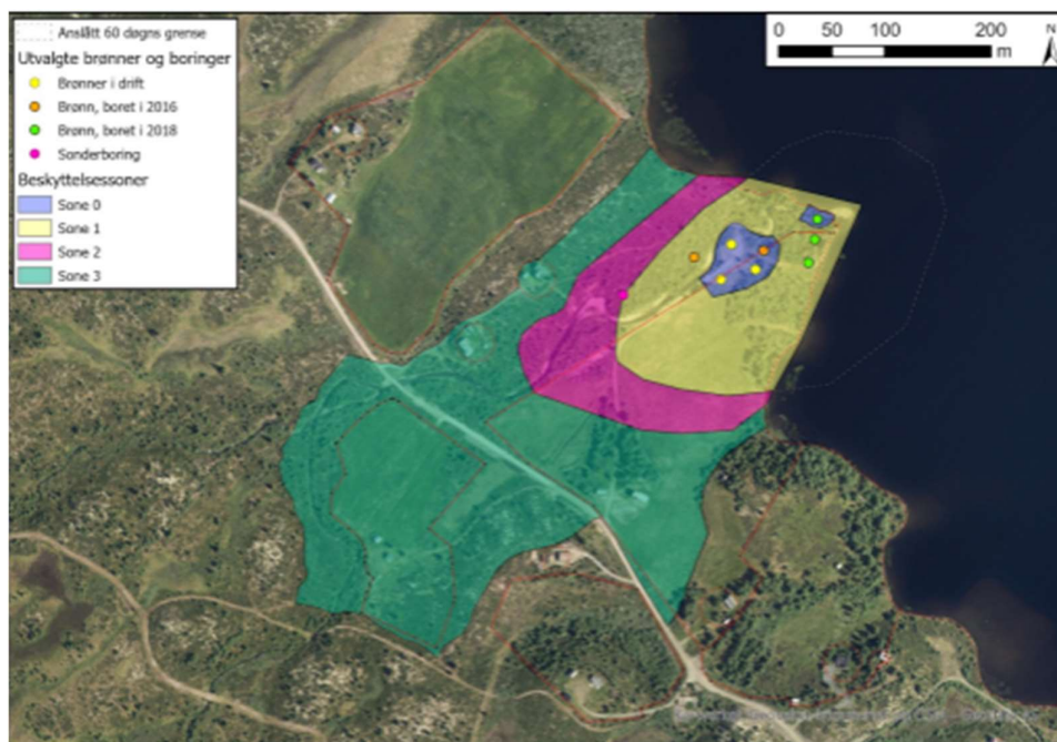
Figur 7: Viser forslag til ny soneinndeling for grunnvannsutttak på Langøddin
