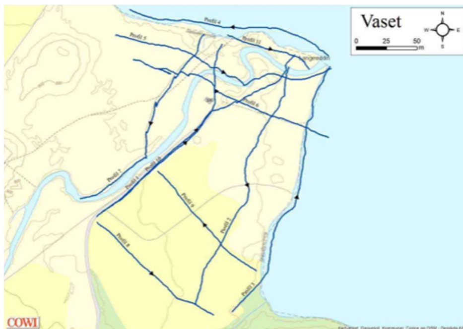
Figur 3: Viser 11 georadarprofiler som er utført på området.
