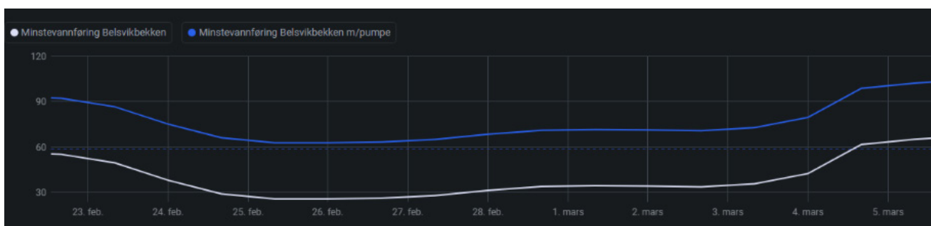
Figur 1. Hvit: Måling på vannmengde gjennom minstevannføringsrør. Blå: Total minstevannføring i periode gjennom minstevannføringsrør og fra ekstra pumpe.
