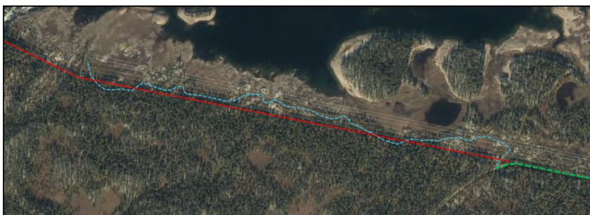
Figur 4: Utsnitt fra norgeskart.no viser ryddebeltet langs 420 kV traséen der Statnetts adkomstvei, blå linje følger under linjen. Rød linje er foreslått trasée i byggeforbudsbeltet 10 meter fra ytterste fase mot sør. Endelig hordsisontal- og vertikal må tilpasses noe, men vil holdes innenfor byggeforbudsbeltet.
