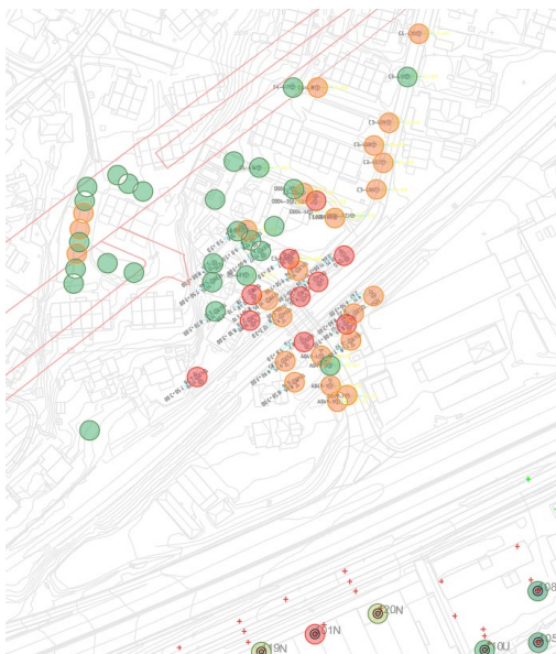
Figur 3-6. Adkomst A. Rødt: påvist sprøbruddmateriale gjennom prøveserie. Oransje: mulig sprøbrudd basert på totalsonderinger. Grønt: antatt leire eller friksjonsmateriale.
