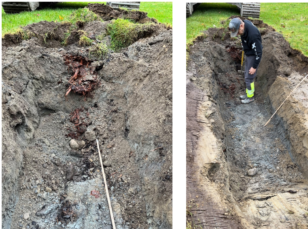
Figur 1D 0 – 1 m. Mye finmateriale (sand). Intakt bark i øverste del (10 – 50 cm). Spor av mer nedbrutt bark på bunn av gropen (1 m).
