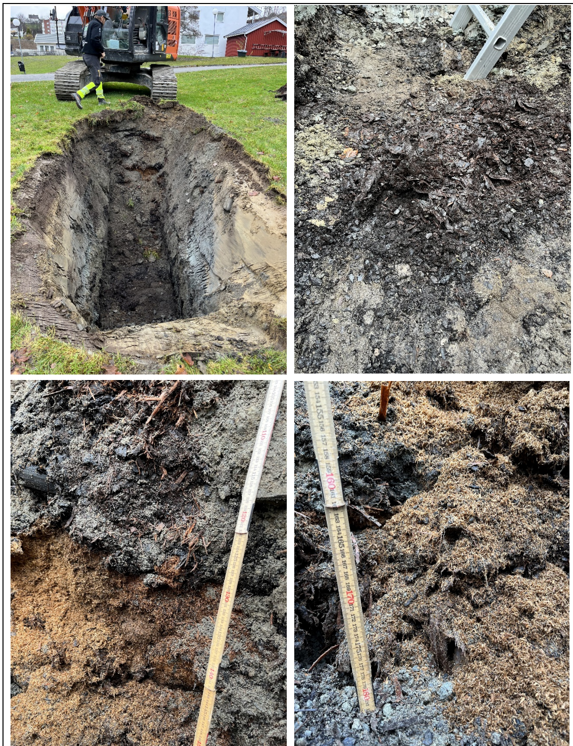
Figur 3D 1.5 – 2 m. Det er observert et område med opphopning av intakt sagflis i en del av gropen, i dybdeintervallet 1.5 – 1.8 m. I bunn (2 m) er det større mengder svært nedbrutt organisk materiale.
