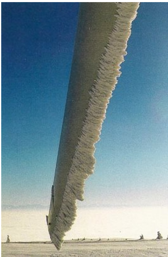
Figur 1-1 Ising på vindturbinblad i Finland. Bildet er gjengitt med tillatelse fra Fins Meteorologisk Institutt.
