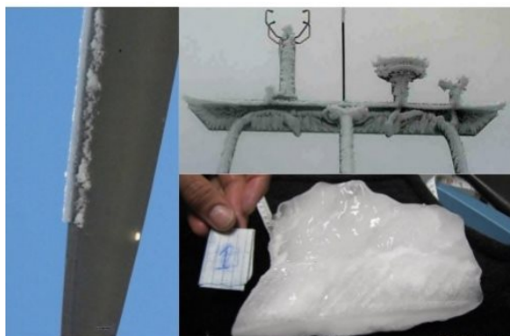
Kat. 4: ISO 129494 islast mellom 1,6 og 2,8 kg/m
