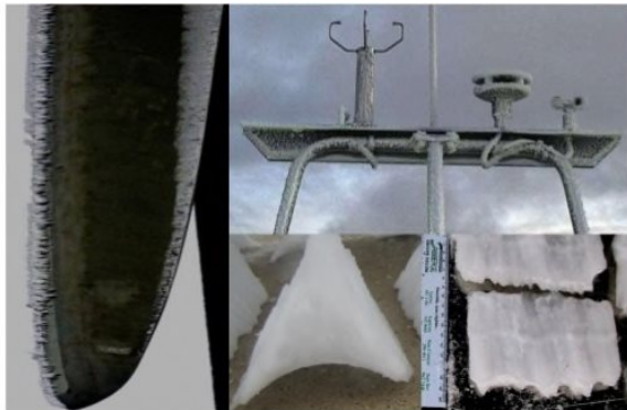
Kat. 5: ISO 129494 islast mellom 2,8 og 5,0 kg/m
