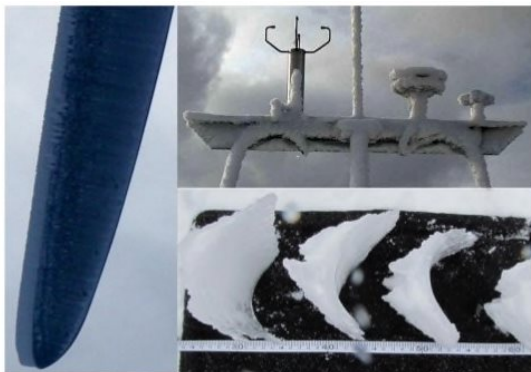
Kat. 5: ISO 129494 islast mellom 2,8 og 5,0 kg/m
