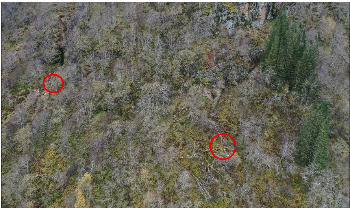
Figur 13: Det er observert enkelte små steinsprangblokker ( <0,5 \text{ m}^3 ) tett på hammarpartia i påverknadsområdet (raud markering). Blokkene er antatt å vere relativt ferske ( <100 år).
