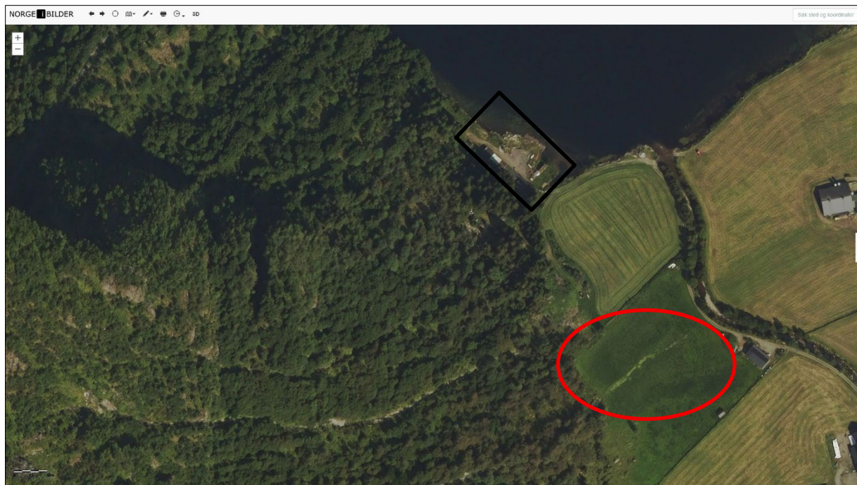
Figur 17: Flyfoto frå 2024. Kartlagt område er innafor svart rektangel. Skogen i påverknadsområdet består hovudsakleg lauvskog og noko grantre. Det er spor etter ei antatt flaumskredhending på bøen søraust for kartlagt område (raud markering). Det er antatt at det går små skred i dreneringsvegen jamleg, då skredsporet er synleg på fleire flyfoto (Figur 19). Vertikalfoto: norgebilder.no
