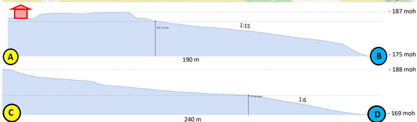
Figur 8: Topografi av skrånende løsmasseterreng sør/sørvest for planområdet. Skråningene ligger over kritisk terrenghelning og høydeforskjell (1:20 og 5m).
