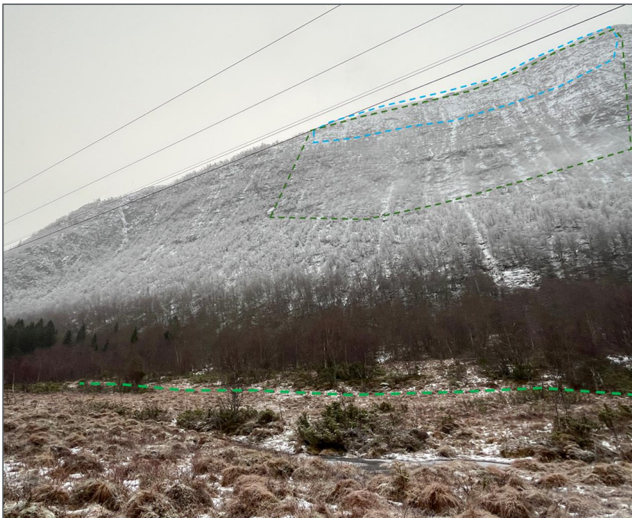
Figur 26 Bilde av fjellsiden som utgjør påvirkningsområdet, som viser potensielle løснеområder for hyppigere og mindre snøskred i blå stiplet polygon og steinsprang i mørkegrønn. Lysegrønn stiplet linje viser omtrentlig skille mellom myrområde mot nord og morenemateriale og skredmateriale mot sør. Bilde tatt mot sør.
