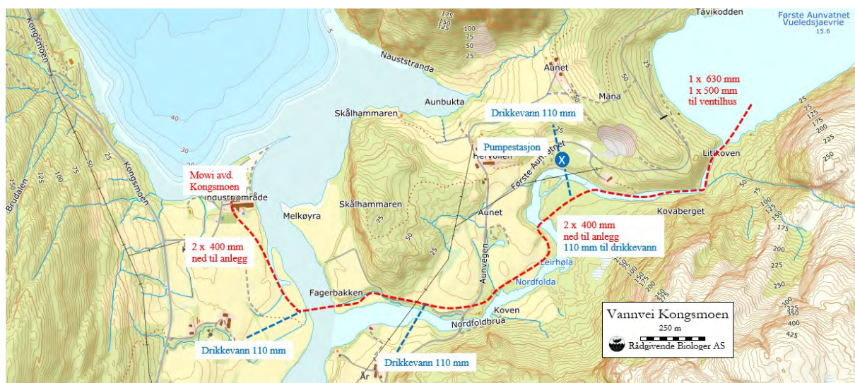
Figur 2. Eksisterende nedgravd ledningsnett for uttak av vann fra Første Aunvatnet.
