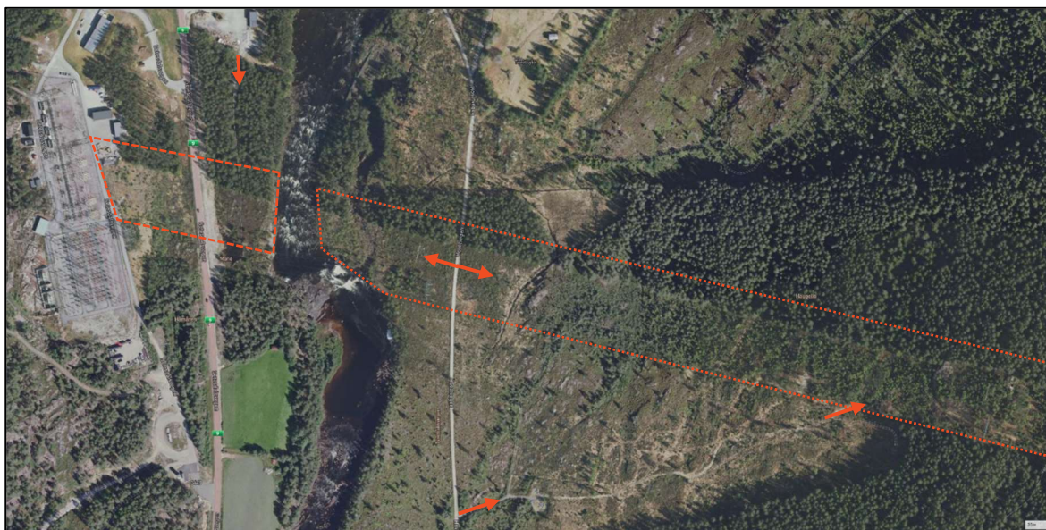
Figur 2.4-4: Adkomst i terreng til anleggsområde for etablering av ny 132 kV ledning Brokke–Bjørgedalen, parsell mellom Brokke transformatorstasjon og Hovetvegen/Tveitebakkvegen . Adkomst fra Brokke stasjon, fra rv. 9 Setesdalsvegen , og fra Hovetvegen/Tveitebakkvegen øst for Otra. Kartgrunnlag fra Kommunekart.
