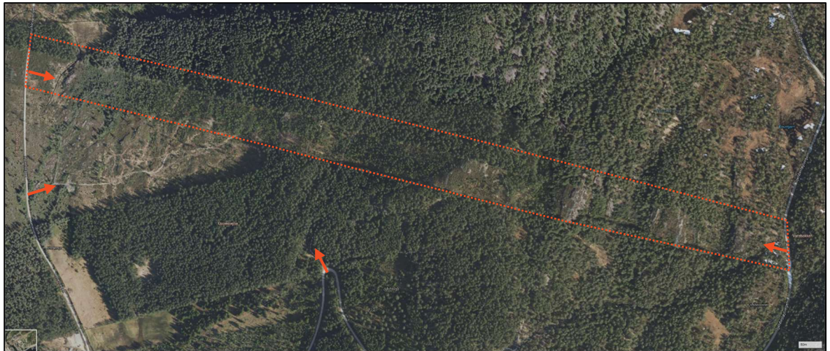
Figur 2.4-5: Adkomst i terreng til anleggsområde for etablering av ny 132 kV ledning Brokke–Bjørgedalen, parsell mellom Hovetvegen/Tveitebakkvegen og Gjerdestøylvegen. Adkomst fra riggområder langs Hovetvegen/Tveitebakkvegen i vest, og fra Gjerdestøylvegen i sør og øst. Kartgrunnlag fra Kommunekart.
