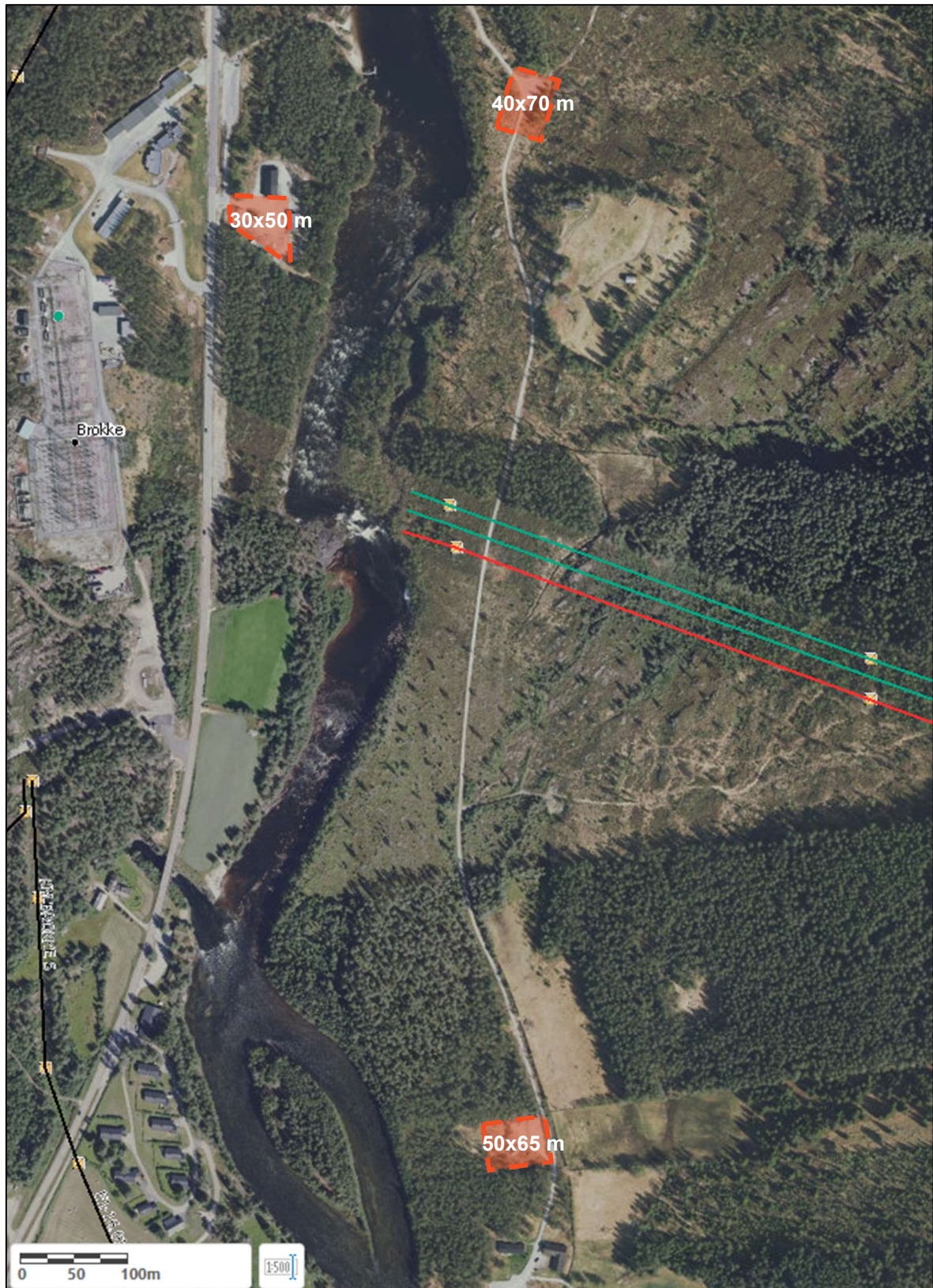
Figur 2.4-12: Midlertidige rigg- og anleggsplasser ved ny 132 kV ledning Brokke–Bjørgedalen, vist med oransje områder. De merkede områdene er omtrent 30 x 50 m, 55 x 65 m, og 40 x 70 m store. Det er plass til å etablere brakkerigg, biloppstillingsplasser og materiallager i områdene. Kartgrunnlag fra NVE Atlas.
