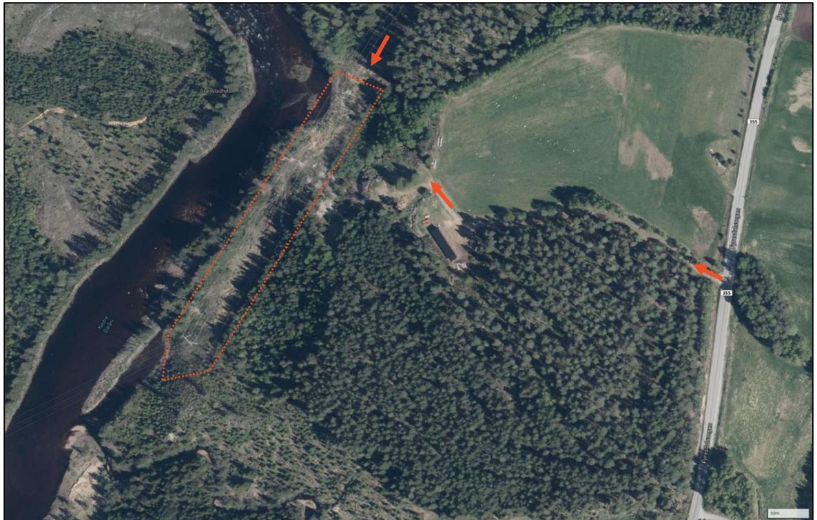
Figur 2.4-2: Adkomst i terreng til anleggsområde for omlegging av eksisterende 132 kV ledning Einangsmoen–Finndøla, øst for Dalåi. Adkomst via fv. 355 Fyresdalsvegen til etablert ryddebelte langs ledningstraséen. Kartgrunnlag fra Kommunekart.
