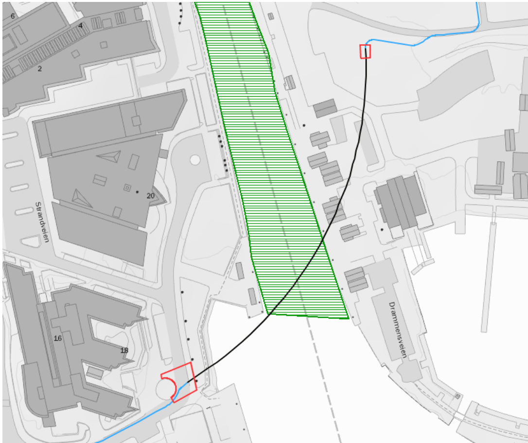
Kart 4: Naturtypen Fåbrofallet-utløp (BN00046122) som er et viktig bekkedrag. På kartet vises omsøkte tiltak. Kabeltrasé for styrt boring under Lysakerelva (svart linje), bore- og mottaksgroper (røde polygon) og kabel i kabelgrøft (blå linje).
