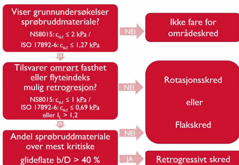
Figur 4.3 Flytskjema for vurdering av aktuell skredmekanisme
